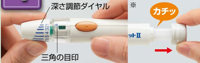
深さ調節ダイヤルを回して穿刺深さを設定します。痛みを最小限にするために、初めてのご使用のときには1から始めて測定に必要な採血量を得る最低の数字に設定してください。
