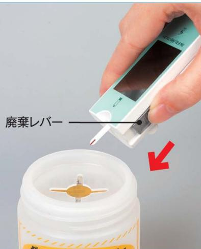
グルテストNeoアルファ側面の廃棄レバーをスライドさせ、使用済みのグルテストNeoセンサーを捨てます。電源が自動的に切れます。
