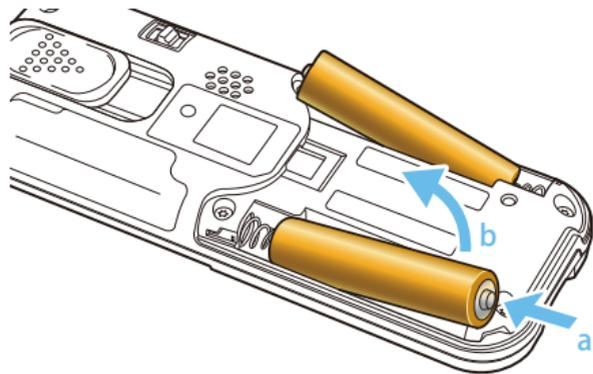
②乾電池の（+）側を矢印の方向に押しながら（a）持ち上げて（b）、取り出します。
